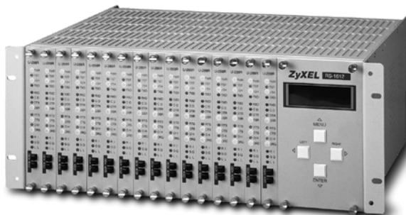
Карта-модуль для модемного блока RS-1612/1612E. Предназначена для работы по коммутируемым, двух- и четырехпроводным выделенным линиям. Управляется с ЖК-дисплея модемного блока
