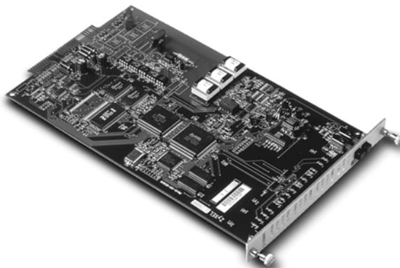
Карта-модуль для модемного блока RS-1612/1612E. Предназначена для работы по коммутируемым и двухпроводным выделенным линиям. Управляется с ЖК-дисплея модемного блока.
