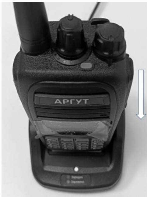
Рис. 5.6. Установка радиостанции на зарядную базу.
