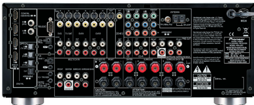
Входы и выходы AV-ресивера Pioneer VSX-LX51
