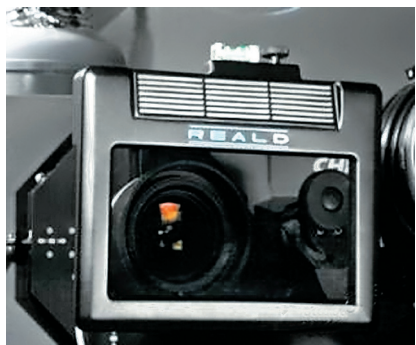
Рис. 9. Поляризующее устройство системы RealD Cinema System
