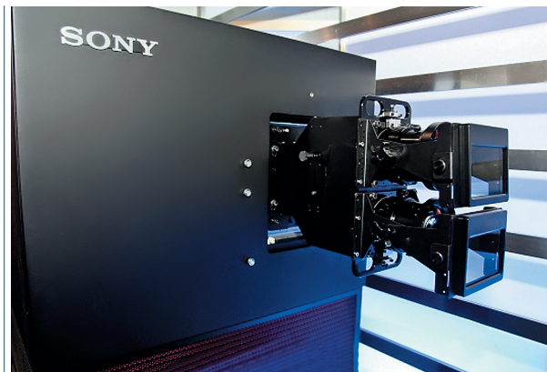
Рис. 11. Система стереопроекции Sony со стереонасадкой с двумя объективами
