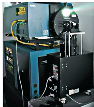
Рис. 10. Подъемный механизм Master Image с вращающимся поляризующим диском
